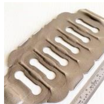
6個取りのバリ。部品重量は単体で15グラム程度。
