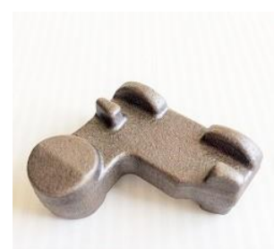
極限まで加工レスを追求し細部だけを加工する。
